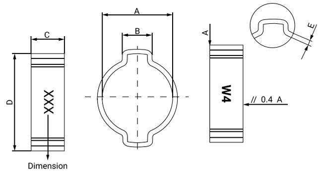
Les colliers 2 oreilles sont une solution économique et assurent une étanchéité dans des tuyaux pour lesquels circulent l'air, le gaz ou fluides.
