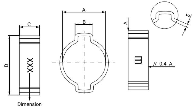
Les colliers 2 oreilles sont une solution économique et assurent une étanchéité dans des tuyaux pour lesquels circulent l'air, le gaz ou fluides.
